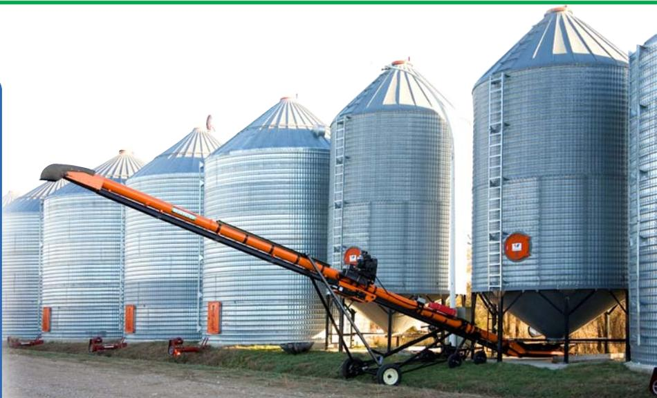
**Система загрузки и разгрузки с помощью передвижных шнеков и ленточных транспортеров не требует сооружения дорогостоящих завальных ям. Зерно может загружаться в емкость прямо из грузовика**
